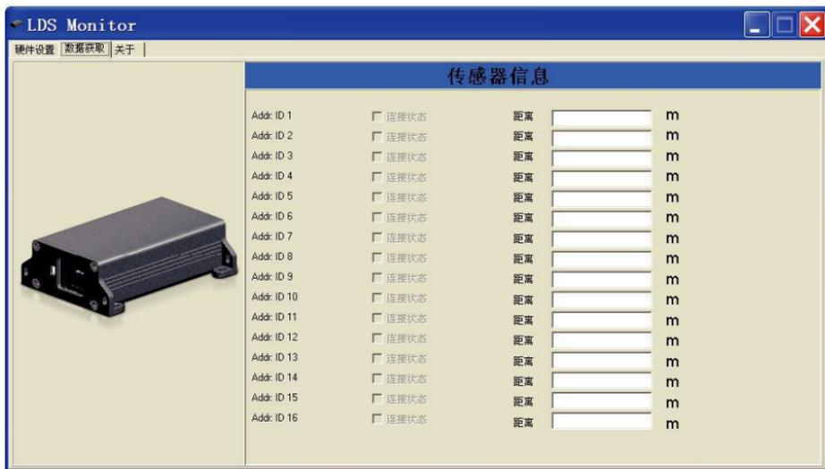
在这个界面中，能最多显示 16 台传感器的连接状态以及测量数据。
